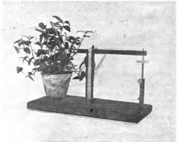
De bovenste plaat van den condensator wordt door den groei der plant verplaatst, waardoor een capaciteits-wijziging plaats vindt
